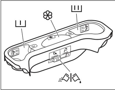
Compartiment pour la phase de pré-lavage. Les repères MAX sont les niveaux maximaux de la quantité de produit de lavage (en poudre ou liquide). Lorsque vous sélectionnez un programme avec une phase de détachage, ajoutez du produit de lavage (en poudre ou liquide).
